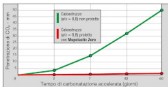
Fig. 2: Effetto di Mapelastik Zero sulla carbonatazione accelerata (30% di CO 2 ) in un calcestruzzo poroso
