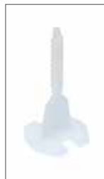
Distanziatori MapeLevel Easy Spacer L Gamma completa di distanziatori a vite, disponibili in tre modelli (lineari, a T e a X) e in cinque spessori di colore diverso: 1 mm (verde); 1,5 mm (grigio); 2 mm (nero); 3 mm (bianco); 5 mm (rosso)
